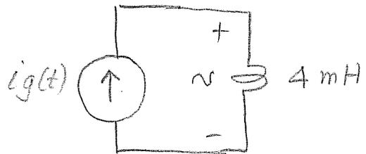
b) Find  $t_1 > 0$  when  $v(t_1) = 0$
